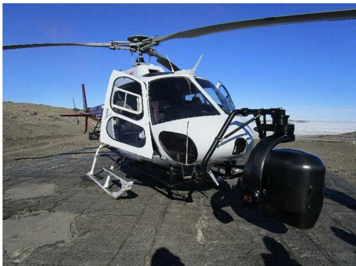
・ASのようなフランスやドイツ製のヘリコプターのメインローターの回転方向は上から見て時計回りです。それに対し、前回のCH-101のようなイタリアやアメリカ製のヘリコプターは反時計回りに回転します。ダウンウォッシュなどの影響を考慮して、時計回りのヘリコプターは左側から搭乗し、反時計回りのヘリコプターは右側から搭乗します。ヘリコプターに搭乗する機会があったら搭乗する側とメインローターの回転方向をパイロットに聞いてみてください。
