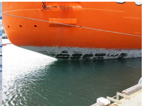
砕氷によって塗装が剥げた船底
